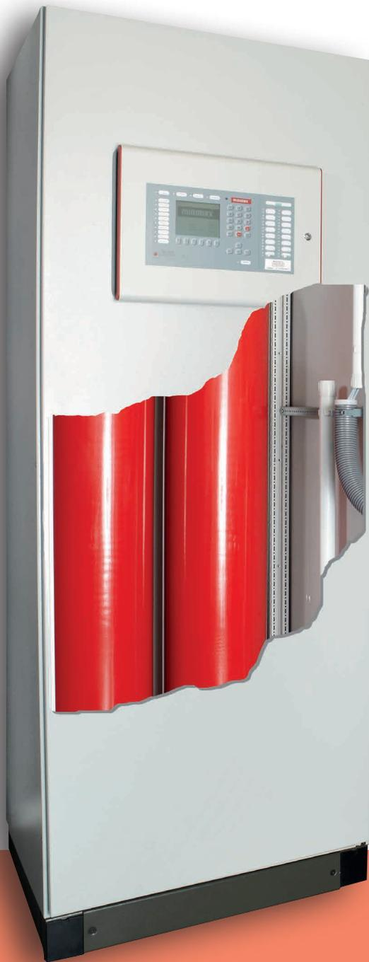
Bei den Kompaktbaugruppen sind alle zentralen Komponenten in einem Schrank zu einer Einheit zusammengefasst und vor Staub, Feuchtigkeit und mechanischer Belastung geschützt. In dem Schrank sind ein oder zwei Löschmittelflaschen sowie eine elektronisch überwachte Schwundanzeige und eine elektromagnetische Löschmittelauslösung zusammengefasst. Die integrierte Brandmelder- und Löschessteuerzentrale steuert im Brandfall die Löscheinheit an.
